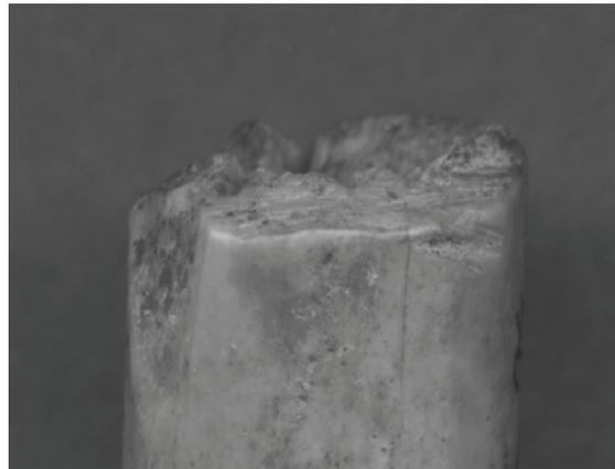
**Fig. 4 - Sciage suivi d'une flexion**
