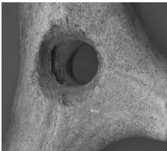
**Fig. 11 – La perforation « par carottage »**
